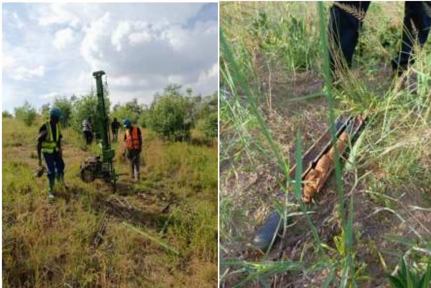
Figure 4: Essai SPT avec prélèvement des échantillons non remaniés
