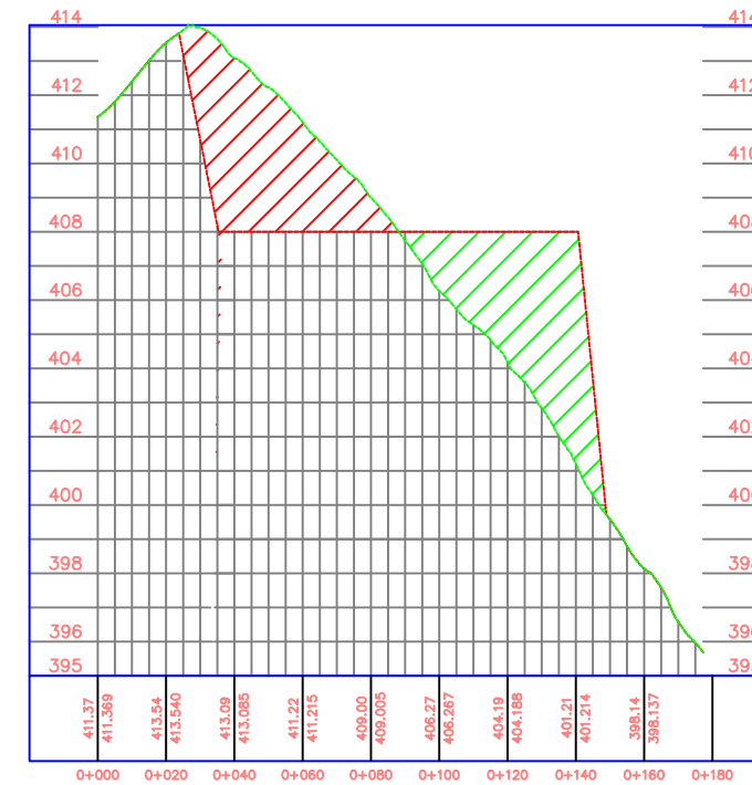
Axe 4: Profil en Travers_Plateforme
