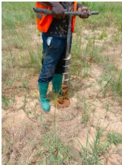
Figure 6: Sondage à la tarière manuelle
